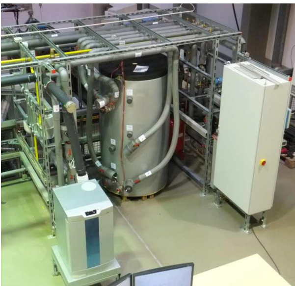
Abbildung 3-13: Mikro-KWK-Prüfstand am Lehrstuhl für Energiewirtschaft und Anwendungstechnik
