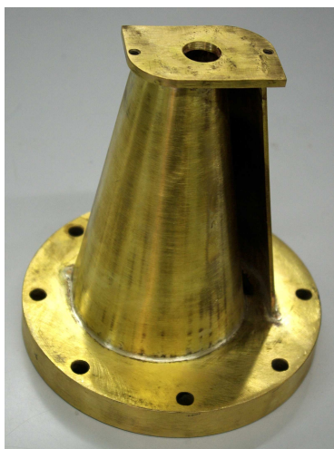
Abbildung 4.9: Messingmodell des modifizierten EV-Brenners für Verbrennungsversuche mit Erdgas
