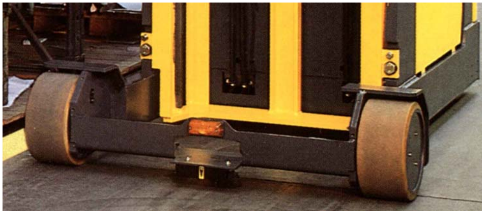
Abbildung 3-9: Anbindung der Räder an den Fahrzeugrahmen (Quelle: Jungheinrich)
