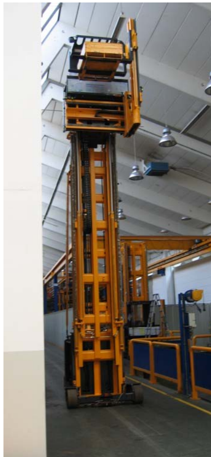
Abbildung 5-1: Gerät für Referenzmessungen, EKX 515 1225 DZ, Fa. Jungheinrich
