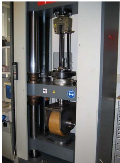
Abbildung 4-11: Ermittlung des Verformungsverhaltens der Vulkollanrollen
