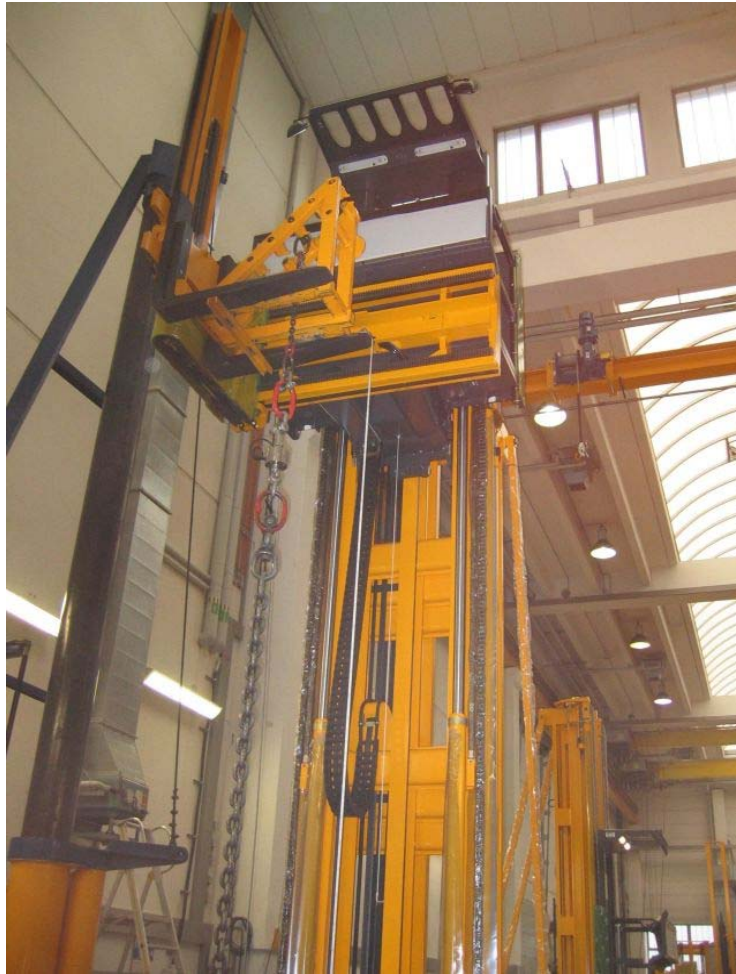
Abbildung 4-5: Versuchsaufbau zur Messung der Elastizität von Hubhydraulik und Hubketten
