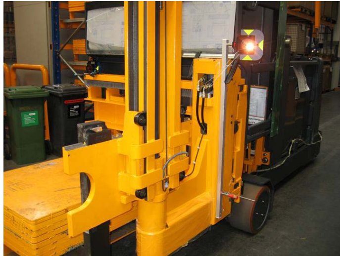
Abbildung 5-4: Reflektoren am Stapler zur Schwingungsmessung
