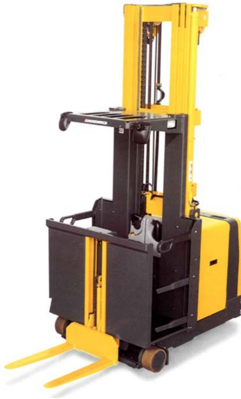
Abbildung 8-2: Vertikalkommissionierer, Fa. Jungheinrich
