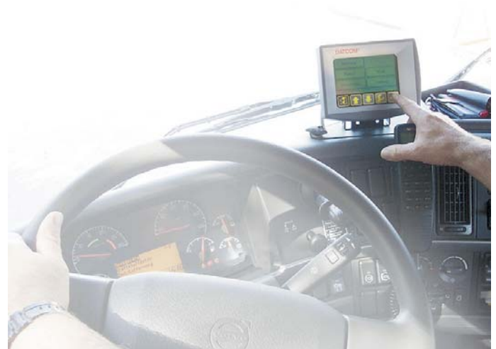
Bild 4: Einbaubeispiel Bordrechner [Foto Max Bögl].
