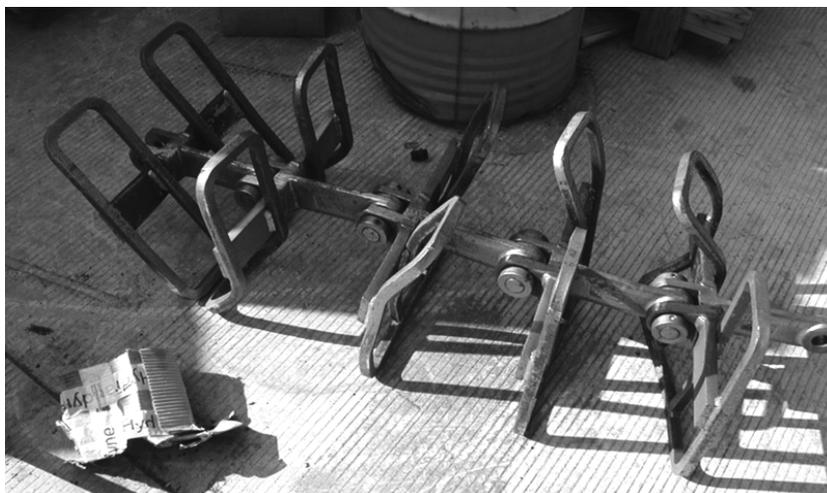
**Bild 1:** Durch Fremdstoffe beschädigte Mitnehmer eines Kettenförderers
