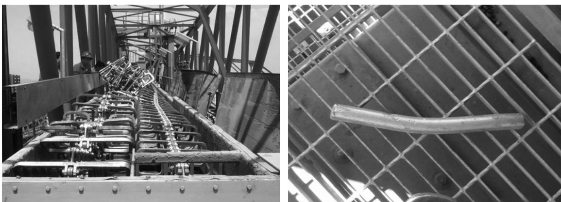
**Bild 3:** Beschädigter Kettenförderer und ursächlicher Fremdkörper
