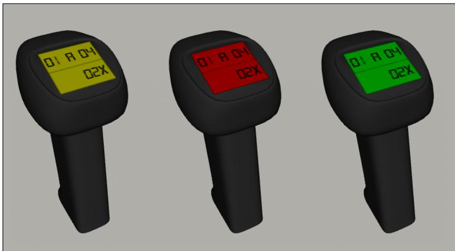
Abbildung 11-8: Statusmeldungen des Barcode-Scanners
