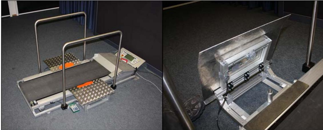
Abbildung 11-4: Konstruktion für den virtuellen Seitwärtsschritt
