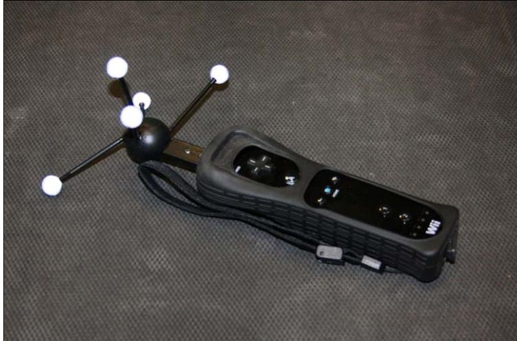
Abbildung 11-6: Interaktionsgerät Wii Remote mit Tracking-Target
