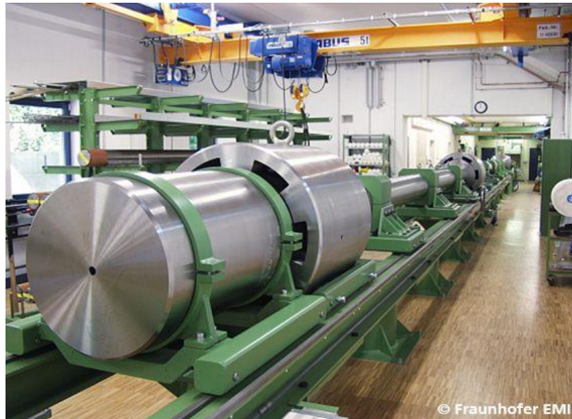
Abbildung 1-7: Blick auf die XLLGG. Zu sehen ist hier die Öffnung der Pulverkammer, in die das Beschleunigungspulver eingefüllt wird (Hoerth et al. [2013]).
