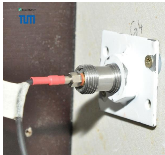
Abbildung 3-17: Halterung für die KRNB-PC Sensoren, hier zusätzlich mit Schrauben am Probekörper fixiert.
