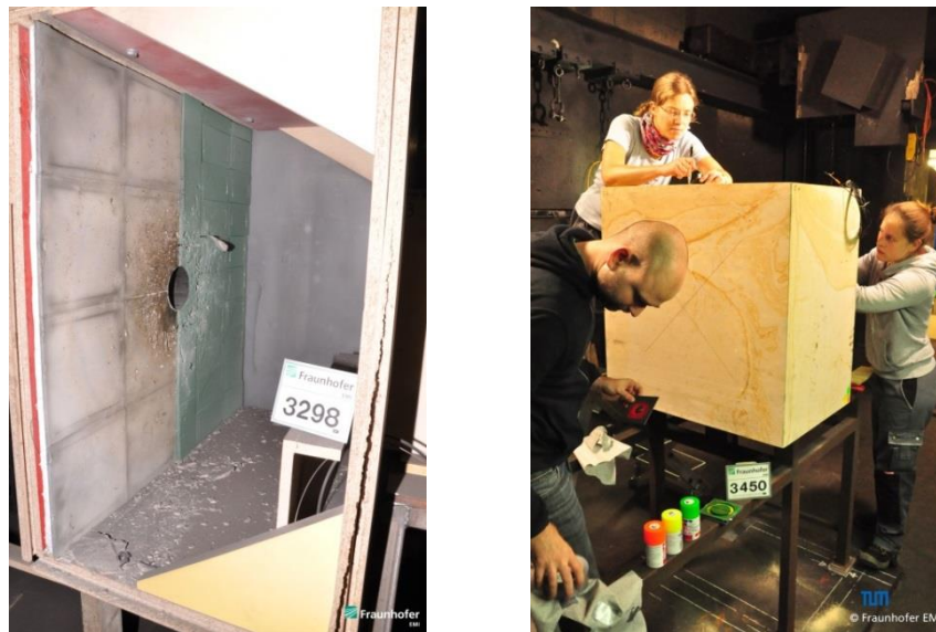
Abbildung 1-6: Links: Ejecta -Fänger zum Auffangen der beim Impact ausgeworfenen Bruchstücke ( Ejecta ). Teilweise mit Vaseline (links) und Blumensteckmasse (rechts). Rechts: Auftragen der farbigen Zielscheibe für den Impact (vorne im Bild) und Anbringung der Sensortechnik für die Schallemissionsanalyse (hinten im Bild).
