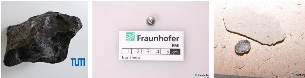
Abbildung 1-9: Bruchstück vom Meteoritengestein Campo del Cielo (ca. 6 kg, 18 cm x 10 cm x 10 cm) (links), angefertigtes Projektil (10 mm Kugel, Campo del Cielo) für ein Impaktexperiment (Mitte) und ein Stück des Projektils nach dem Impact (rechts).
