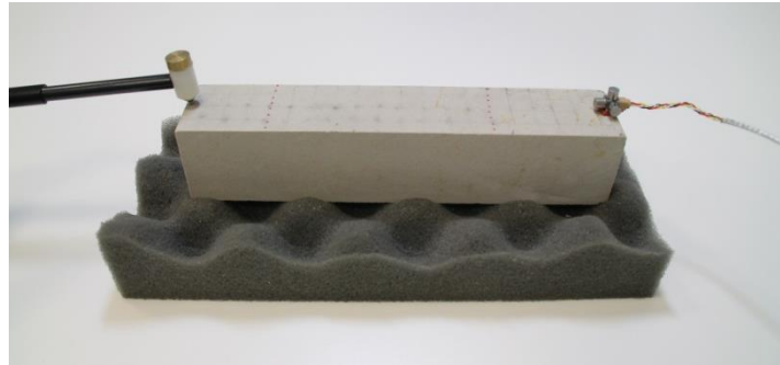
Abbildung 3-32: Sandsteinprisma, gelagert auf Schaumstoff. Die Anordnung von Hammer und Sensor ist geeignet um eine flexurale Schwingung anzuregen und aufzunehmen.
