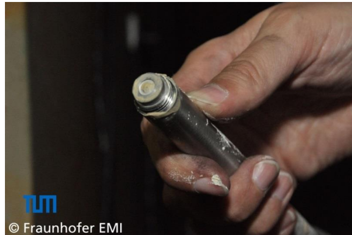
Abbildung 3-18: Sensorhalterung für die Sensoren in den Bohrlöchern. Hier nach einem Experiment mit teilweise gesättigtem Sandstein. Durch das Sandstein-Wasser-Gemisch kommt es zu starken Verschmutzungen der Sensorik.
