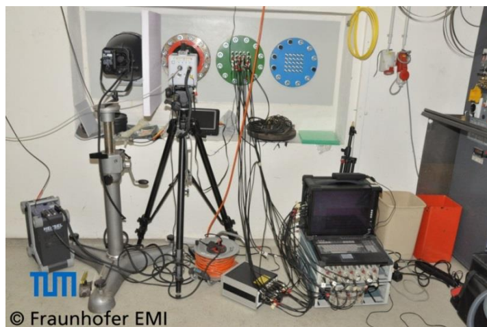
Abbildung 3-12: Aufbau der SEA Messtechnik außerhalb der XLLGG Targetkammer. Von links nach rechts: Blitzlicht (EMI), Hochgeschwindigkeitskamera (EMI), SEA Messtechnik mit Transienten-Rekorder (TUM) und Vorverstärker (TUM).
