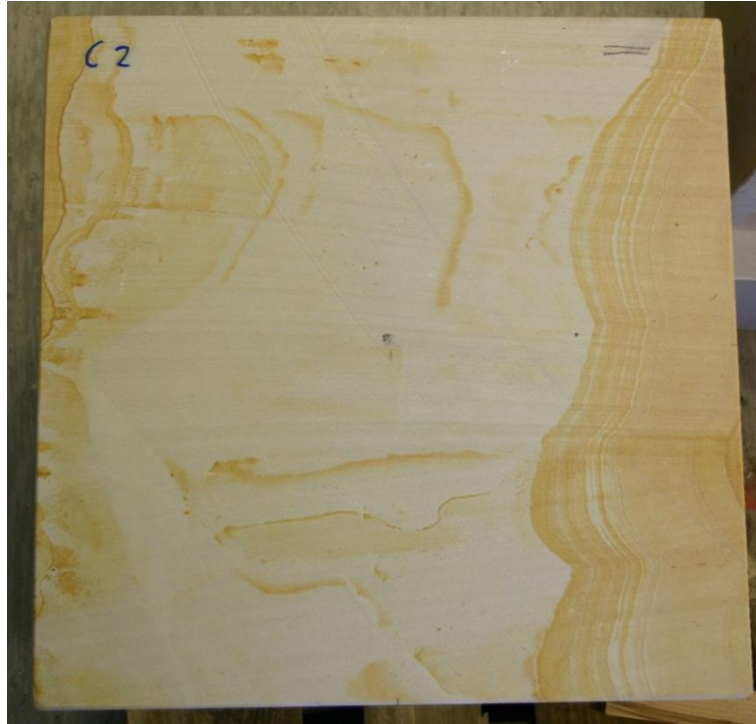
Abbildung 4-8: Sandstein-Probekörper mit 30 cm Kantenlänge. Die Schichtung ist schon übergeordnet (hier horizontal) sichtbar. Oben rechts ist die Schichtung schematisch eingezeichnet. Zusätzlich sind Färbungen durch Wassereinlagerungen und zusätzlichen Mineralen erkennbar (vorwiegend vertikal).
