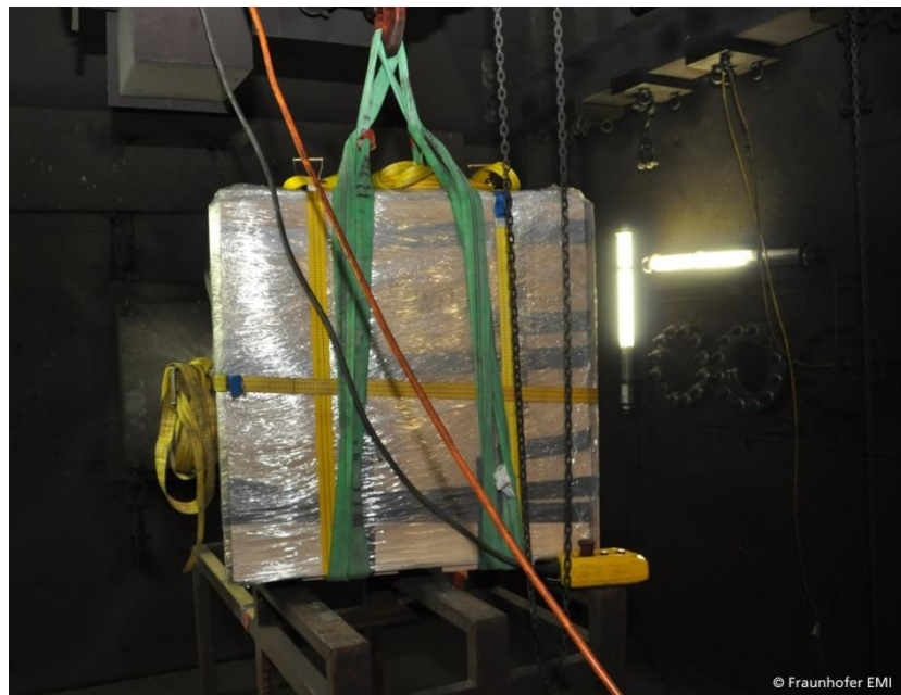
Abbildung 1-5: Quarzit-Probekörper, der mit einem Kran aus der Targetkammer der XLLGG herausgehoben wird. Die Kantenlängen betragen hier 80 cm x 80 cm x 40 cm und das Gewicht liegt bei etwa 665 kg.
