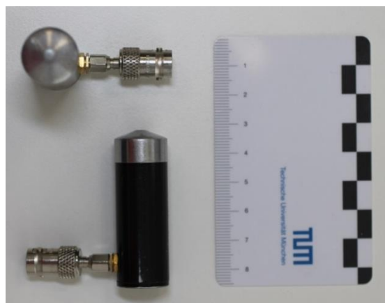
Abbildung 3-22: Geotron Sensoren. Ein Sensor fungiert als Geber (UPG-D) und ein Sensor als Empfänger (UPE-D). Die Kontaktfläche an der Spitze beträgt bei beiden etwa 2-3 mm im Durchmesser.
