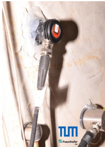
Abbildung 3-14: V103 Sensor für die SEA mit einer großen Menge Heißkleber für eine bessere Fixierung an der rauen Oberfläche.
