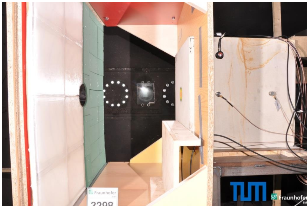
Abbildung 3-2: Experimenteller Aufbau in der Targetkammer an der XLLGG. Von links nach rechts: in einem Holzkasten eingebauter Ejecta -Fänger, Sandstein- Probekörper mit an der Oberfläche platzierten Ultraschall-Sensoren.
