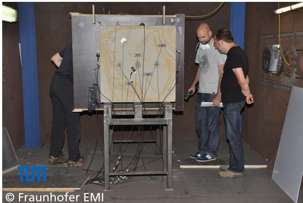
Abbildung 3-13: Ein Blick in das Innere der begehbaren XLLGG Targetkammer mit Sandstein Probekörper und SEA Sensorik. Um den Probekörper herum ist ein Holzkasten zum Auffangen des ausgeworfenen Materials. Unten links ist ein Steg zum Schutz der Kabel zu sehen.
