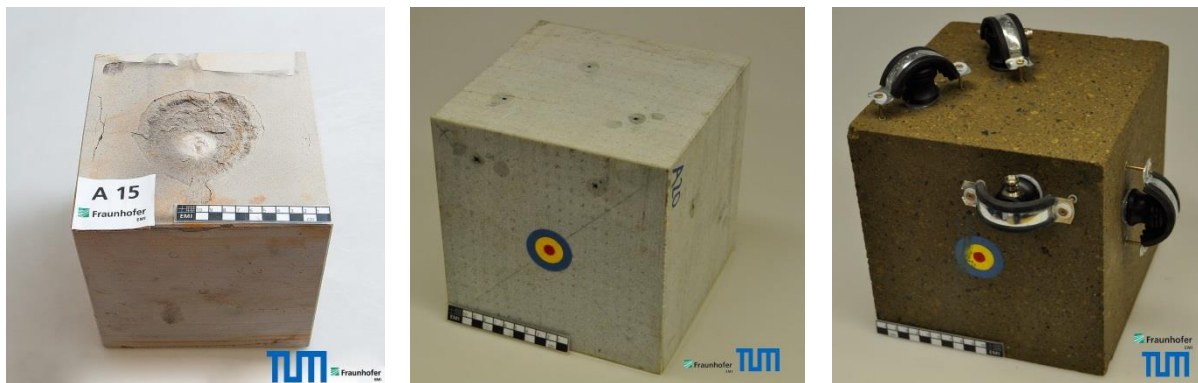
Abbildung 1-8: Drei Probekörper aus den drei unterschiedlichen Materialien. Von links nach rechts: Trockener Seeberger Sandstein mit Krater nach dem Experiment; Trockener Taunus Quarzit vor dem Experiment mit Zielscheibe; Wassergesättigter Weiberner Tuff vor dem Experiment mit Zielscheibe und befestigten Sensoren.
