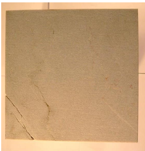
Abbildung 4-10: Drei Seitenansichten eines Quarzit-Probekörpers (Block A21) jeweils auf der linken Seite und drei Seitenansichten der dazugehörigen Ultraschall-Tomographie an der Oberfläche auf der rechten Seite. Hier sind deutlich die Bruchkanten eines Keils im Block zu erkennen. Von oben nach unten: Bruchkante rechts, Bruchkante links, Bruchkante unten links.
