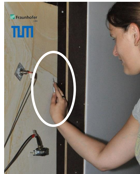
Abbildung 4-5: Links – Schematische Erklärung des Bleistiftminentests (Hsu-Nielsen-Quelle). Über die Bleistiftminen wird ein Teflon-Schuh gesetzt, sodass ein 30° Winkel zur Oberfläche entsteht (Augsburg [2013]). Rechts – Praktische Durchführung eines Bleistiftminentests an einem Sandstein-Probekörper.
