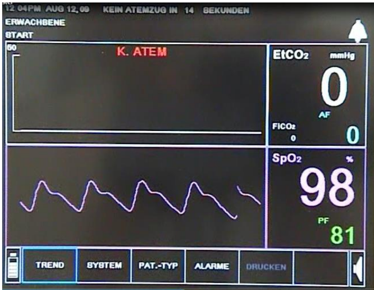
Abb. 7: vom Kapnographen erkannte Apnoe mit rotem Warnhinweis über fehlende Atmung und Protokollierung der Apnoedauer am oberen Bildschirmrand (Foto: Stefan von Delius, Klinikum rechts der Isar der Technischen Universität München)
