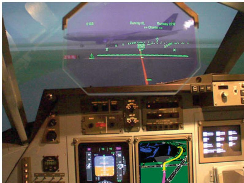
*Abbildung 6.3: Kontaktanaloges Head-up Display im T-NASA-System, das den Weg über den Taxiway darstellt [29].*
