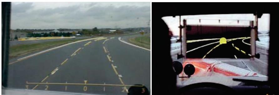
Abbildung 6.4: Künstliche Sicht im Head-up Display einer Schneefräse [32]
