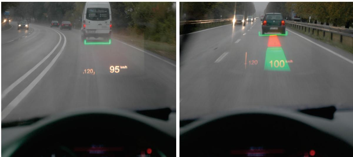
Abbildung 7.2: Die Anzeigen von ACC-low (links) mit Klammer zur Markierung des Regelobjektes und der Sollgeschwindigkeit und ACC-high (rechts) mit zusätzlicher Darstellung des Regelbereiches.
