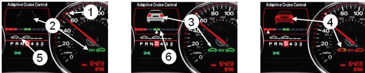
Abbildung 7.1: Die einzelnen Anzeigen des ACC im Audi A8 (D3)
