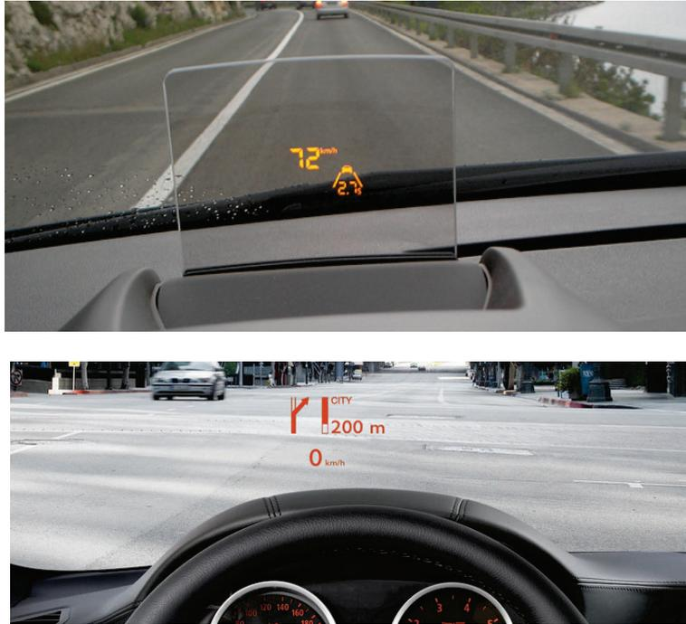
*Abbildung 4.9: Unterschiedliche Positionierung des virtuellen Bildes: Das obere Head-up Display weist einen inhomogenen Hintergrund (Fahrbahn und Motorhaube) auf, was zu erschwertem Able-
