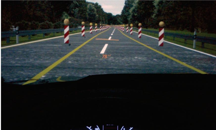
Abbildung 7.32: Balkenanzeige innerhalb der Autobahnbaustelle
