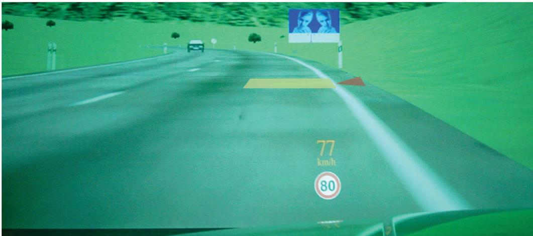
*Abbildung 6.1: Kontaktanaloge optische Querführungsassistenz mit einem Balken, der den Kurs des Fahrzeugs veranschaulicht, und einem roten Dreieck für die Spurverlassenswarnung [28].*
