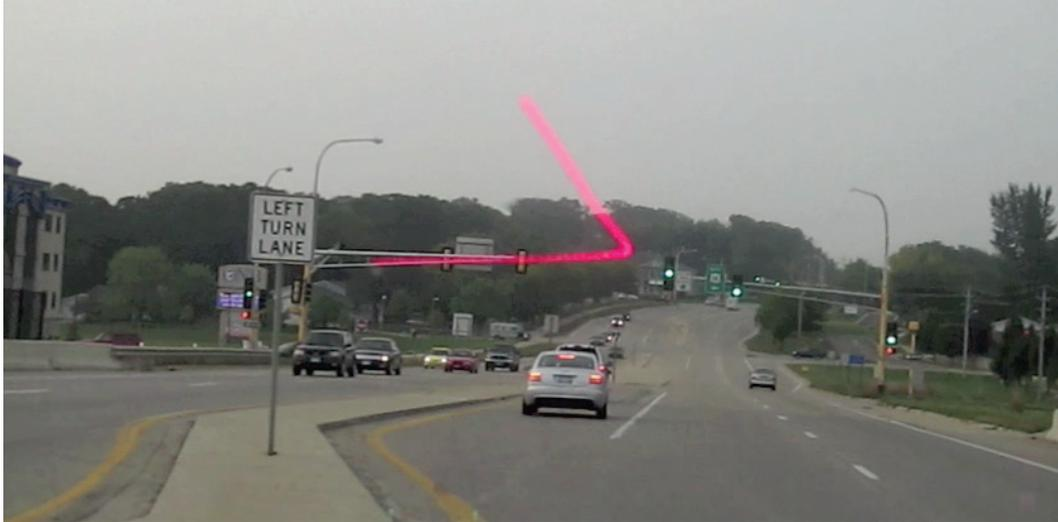
*Abbildung 6.2: Darstellung des Navigationspfades über der Fahrbahn im Virtual Cable™ [21]*
