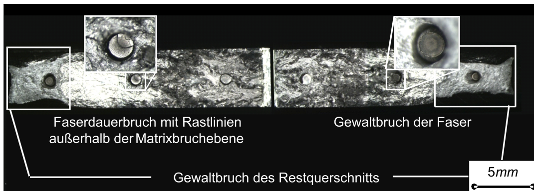
Abbildung 8.4.: Bruchfläche einer heterogen verstärkten Risswachstumsprobe; die Fläche des initialen Schadens (mitte) ist nicht dargestellt [Zaf09]
