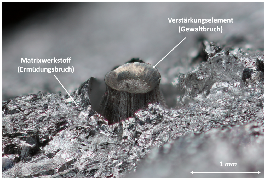
Abbildung 8.6.: Detailaufnahme eines durch Gewaltbruch zerstörten Verstärkungselements; das Verstärkungselement liegt im Bereich der Risszone des Matrixwerkstoffs und wurde erst beim Bruch der Probe zerstört
