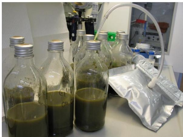
**Abbildung 13:** Anaerobenflaschen und Gasbeutel für Gasanalyse
