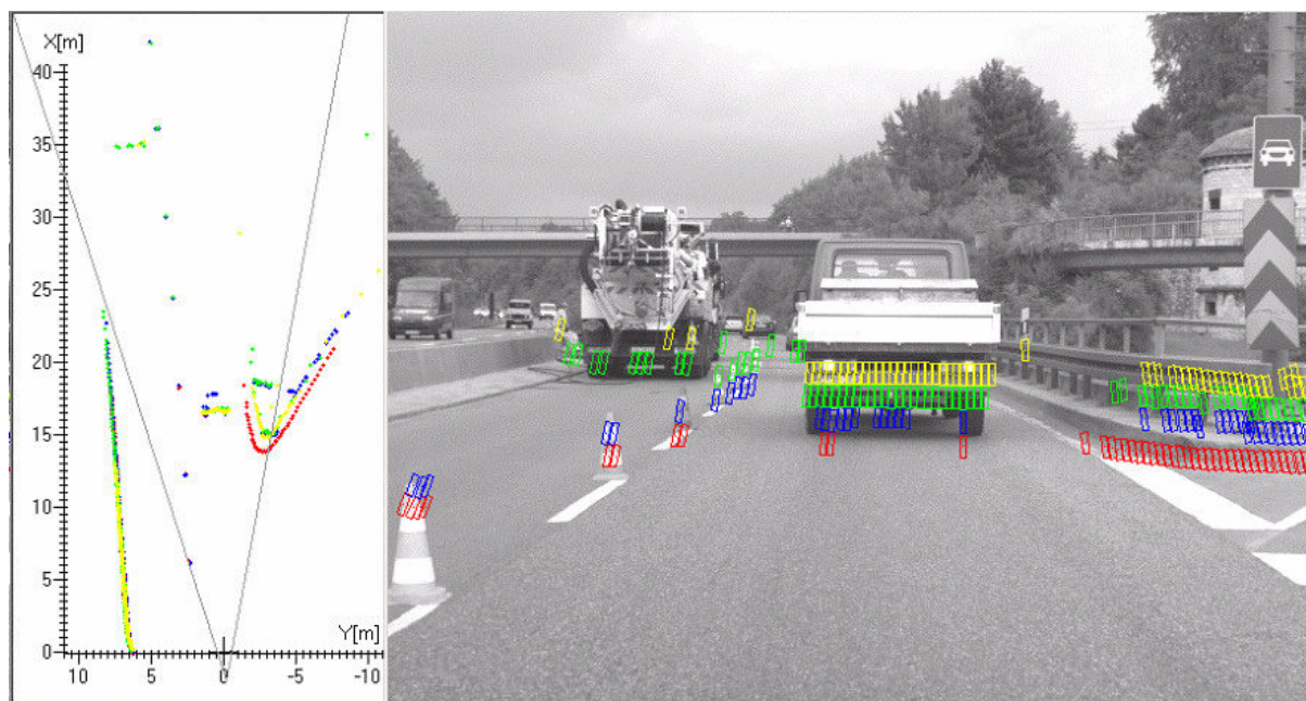
Abbildung 2: Links: Messdaten des Laserscanners aus der Vogelperspektive. Der durch die grauen Linien aufgespannte Winkelbereich gibt den Sichtbereich der Kamera an. Rechts: Laserscannerdaten in das Videobild projiziert.
