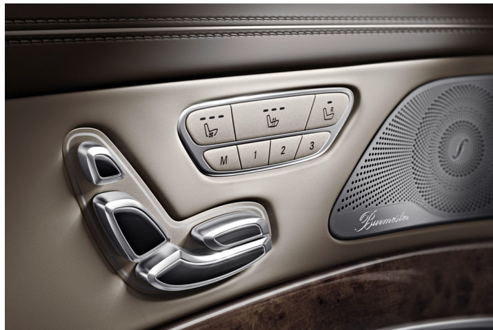
Abbildung 2.2: Formkodiertes Bedienelement zur elektrischen Sitzverstellung, Quelle: Daimler AG, Mercedes-Benz S-Klasse (2013, W222), Pressefoto, Fotonummer 13C302_06
