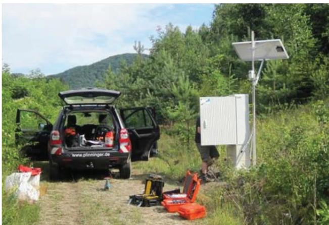
Abb. 5: Autarke Datenerfassungsstation. Erkennbar der GFK-Schrank für Loggereinheit, Laderegler und Pufferakku sowie der 3,0 m hohe Mast mit Solarpaneel und GSM-Antenne.
