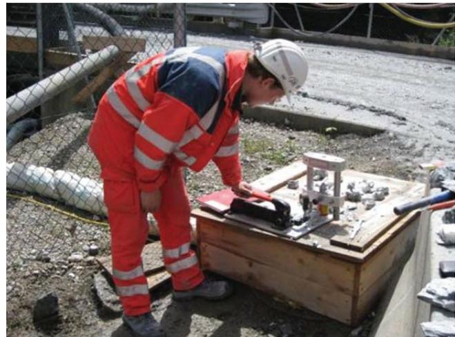
Abb. 5: Punktlastversuch vor Ort. Durch die Anwendung dieses indirekten Prüfverfahrens an unregelmäßigen Handstücken („irregular lump test“) konnten zeitnah und in ausreichender Menge repräsentative Indexwerte für die Einaxiale Druckfestigkeit ermittelt werden (Foto: Plinninger).
