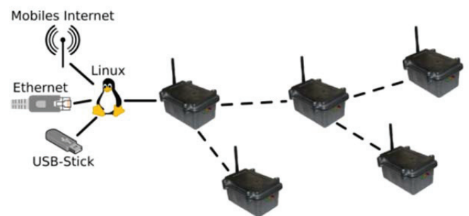
Abb. 1: Aufbau des X-SLEWS-Systems mit einem Linux-basierten Gerät als Gateway.
