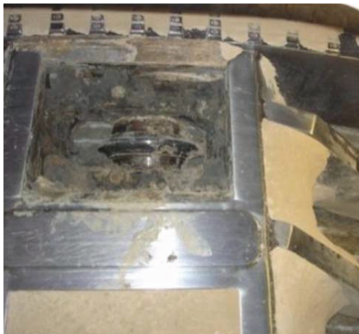
Abb. 1: Verklebter Meißelkasten einer EPB-TBM.
