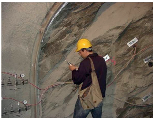
Abb. 1: Bestimmung der Druck- und Scherfestigkeiten des Opalinustons mithilfe des Nadelpenetrometertests im Felslabor Mont-Terri, Schweiz.
