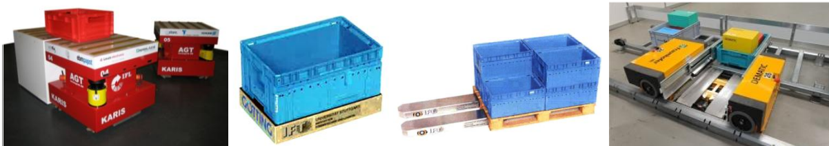
Abbildung 2-8: Prototypische Umsetzungen kleinskaliger Flurförderzeuge: KARIS, KaTe, Doppelkufensystem, Multishuttle Move (v.l.n.r., Bildquellen: IFL, IFT/Götting, IML/Dematic)
