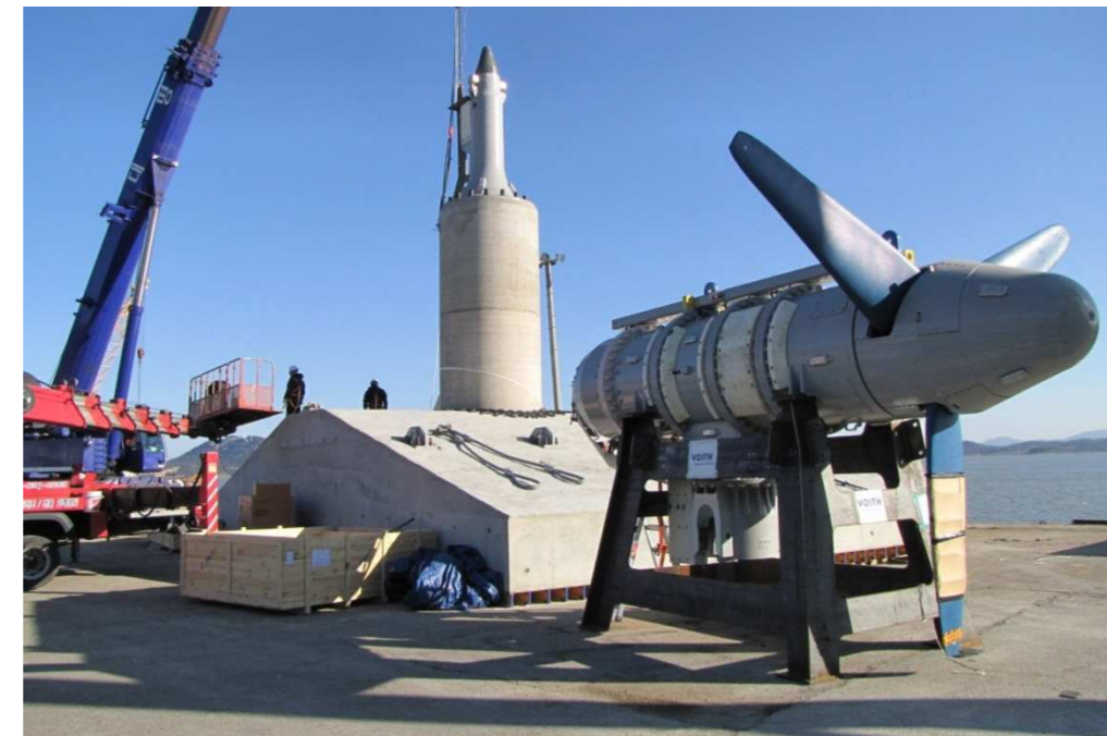
Tidal turbine prototype [RENETEC & VOITH]
