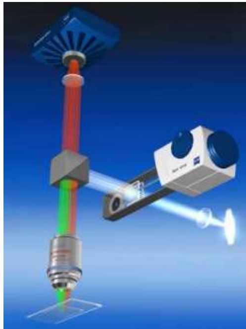
Abbildung 4: Darstellung des Lichtweges im im ApoTome: Trifft das Anregungslicht auf die Glasplatte, wird die Gitterstruktur in den Anregungsstrahlengang "eingepägt" und in die Fokusebene des verwendeten Objektivs projiziert. Abbildung aus (INTERNETLINK_1).
