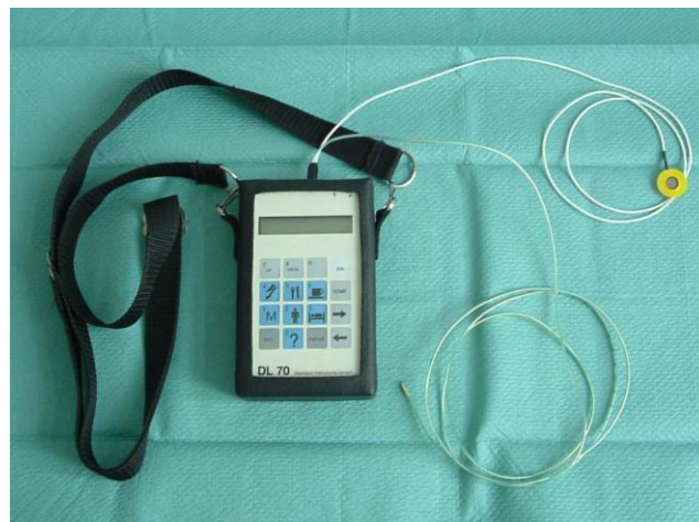
Abb. 8: 24h-pH-Metrie-Messgerät mit angeschlossener 2-Kanal-Sonde
