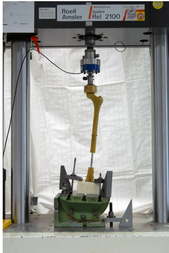
Figure 1.1: Universal testing machine Roell Amsler. Division of Biomechanics. Klinikum rechts der Isar of the Technische Universität München, Germany
