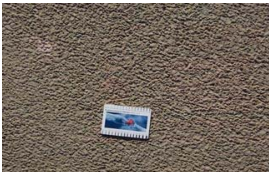
Bild 5: Waschbetonoberfläche mit einem CEM III/A 42,5 N
