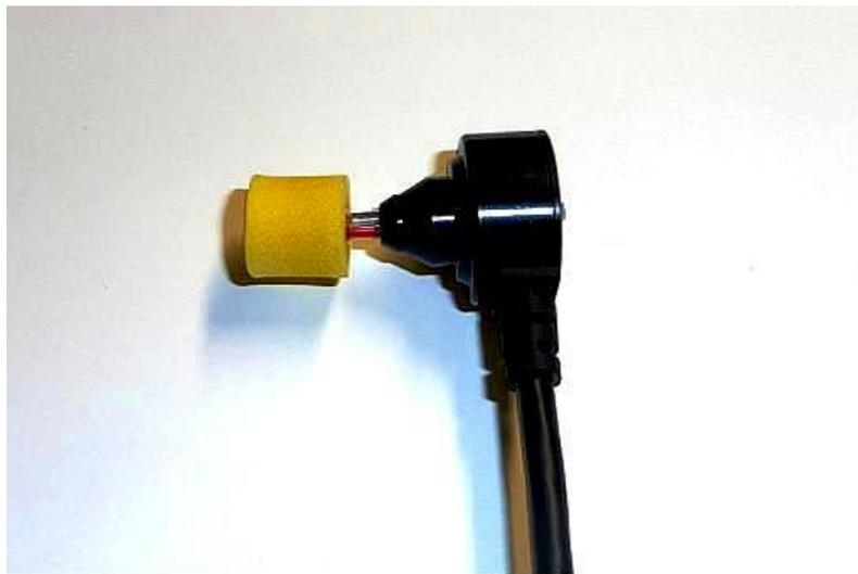
**Abb. 4:** Messsonde mit Ohrstöpsel zur Registrierung der DPOAE.
