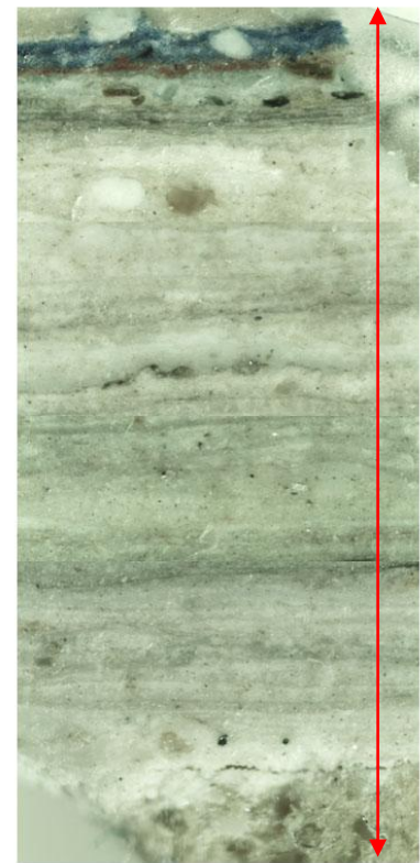
Probe K18 Entnommen aus Befundstelle 104b1, eingebettet in Technovit, 50fache Vergrößerung
