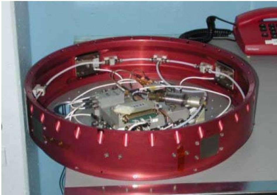
**Abbildung 3-1: MAXUS-5 GPS Antennen-Modul (mit Orion-HD Empfänger und zwei redundanten Dual-Patch Antennen-Subsystemen)**
