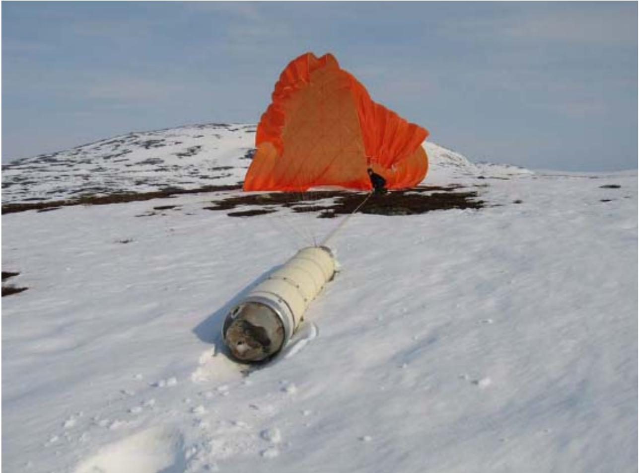
**Abbildung 6-39: MAXUS-7 – Bergung der Nutzlast [Hörschgen, [47], 2006]**
