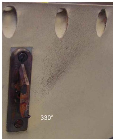
**Abbildung 6-15: Geschmolzene S-Band-Antenne bei  $Pos_{SBandAnt} = 330^\circ$**
