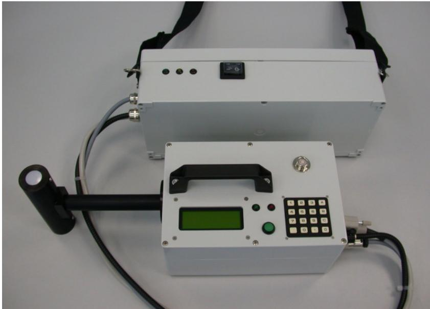
Abbildung 5. Außenansicht des Spektrometers. Oben die schultergetragene Zentraleinheit, darunter das Kopfteil mit Tastatur, Punktwasserwaage und den Objektiven (Foto: E. Stickse).
