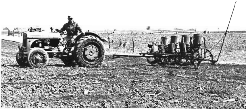
Abb. 2: Vierreihige Maispflanzmaschine grosse Behälter für Handelsdünger kleine Behälter für Maissaatgut
