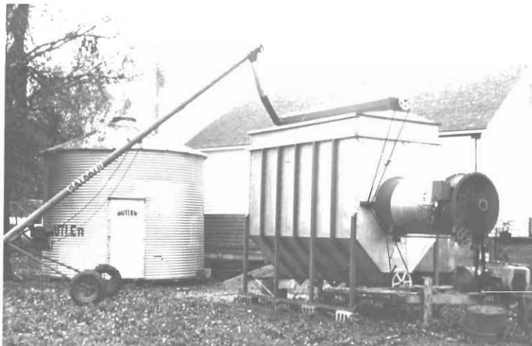
Abb. 9: Spezialtrocknungsbehälter für Körnerfrüchte mit angeflanschem Universal-trocknungsgerät (im Hintergrund ein Wellblechgetreidesilo)
