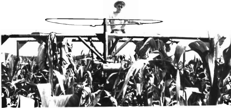
Abb.1: Entfahnungsmaschine bei der Arbeit
