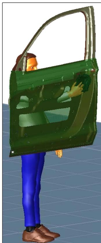
Abbildung 6-4: Zugänglichkeits- und Ausbauanalyse eines Türschlosses
