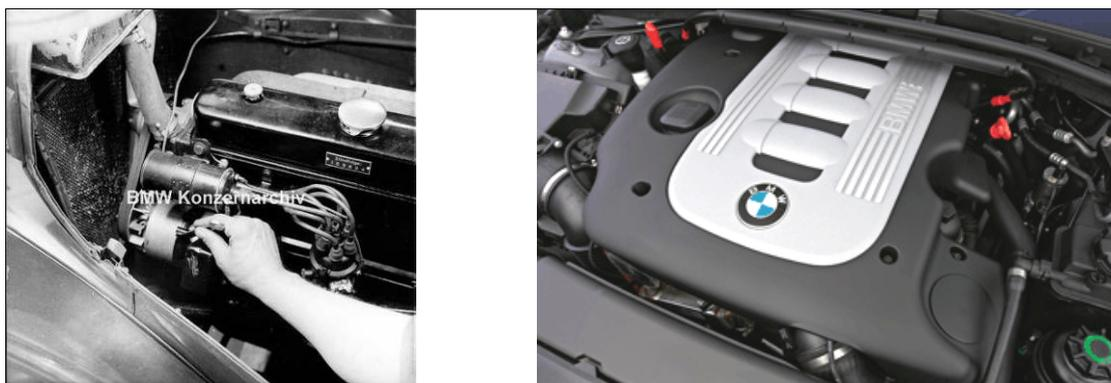
*Abbildung 1-2: Entwicklung der Bauraumdichte im Motorraum im Laufe der Zeit. Links: BMW 320-326 (dreißiger Jahre). Rechts: BMW 3er (Modelljahr 2009) [11]*
