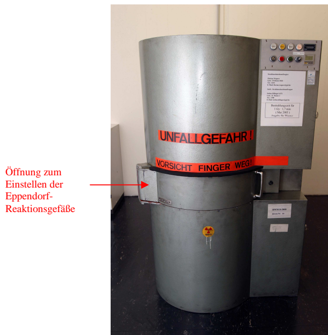
Abbildung 9: Caesium-137-Quelle des Helmholtz-Zentrums (Quelle: BfS)
