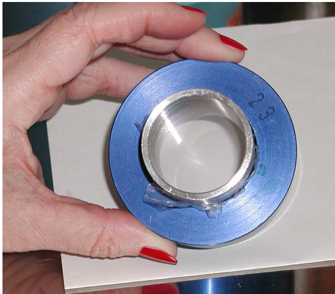
Abbildung 6: Zur \alpha -Bestrahlung der HSC45-M2 Zellen und Lymphozyten benutzte Edelstahlringe mit eingespannter Mylarfolie (entwickelt von Dr. Roos, Helmholtz-Zentrum (Quelle: BfS))
