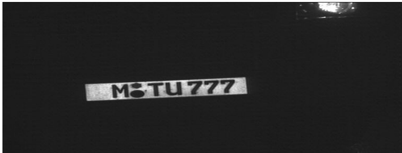
Abb. 3.2 Basis für OCR: erfasstes Foto einer Aktiv-Infrarotkamera
