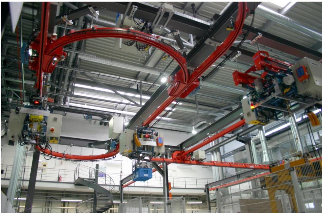
Abbildung 6-11 EHB-Anlage in der Versuchsanlage des Lehrstuhls fml
