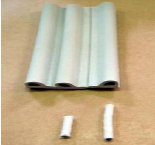
**Abb. 2.16:** In dieses Kunststoffgewebe waren die darunter abgebildeten Drähte eingebracht. Es konnte kurze, lange oder keine Stenosen geben.
