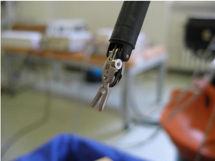
**Abb. 2.5: Der Mikrogreifer am distalen Ende des haptischen Instruments**
