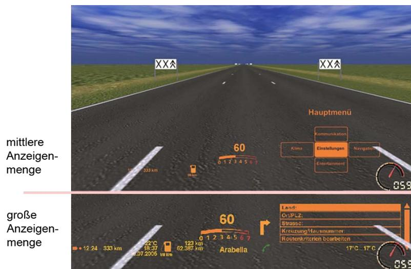
Abbildung 8.33: Die zwei verschiedenen Anzeigemengen im HUD
