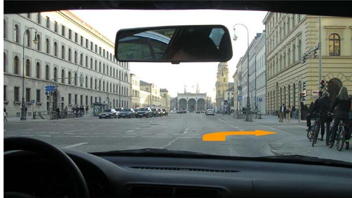
Abbildung 8.16: Kontaktanaloge Darstellung eines Navigationspfeils
