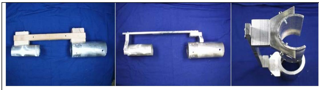
**Abbildung 15: Aufbau der Halterung zur Referenzierung und zur exakten Repositionierung (links: ursprüngliche Form mit Holzverbindung, Mitte und rechts: endgültige Halterung aus Aluminium).**
