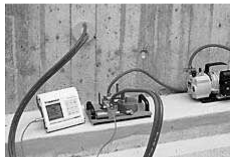
Abbildung 21: Permeabilitäts-Tester nach Torrent; schematische Darstellung (li.) und Ansicht (re.)
