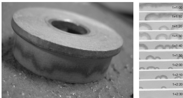
Abbildung 44: Lackmuspapieretest, Ausführung (li.) und Ergebnis (re.)
