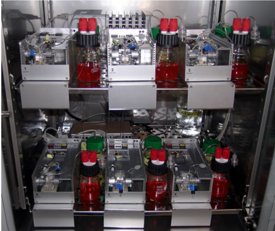
Abbildung 4-19: Stationärer 6-fach IMOLA Aufbau zur parallelen Untersuchung von sechs Zellproben.
