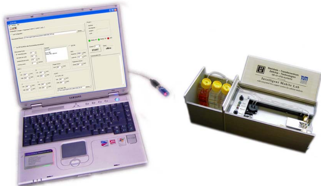
Abbildung 4-18: Rechts: IMOLA mit Fluidikmodul und integrierter Spannungsversorgung. Links: Laptop mit drahtloser Schnittstelle und Steuersoftware.
