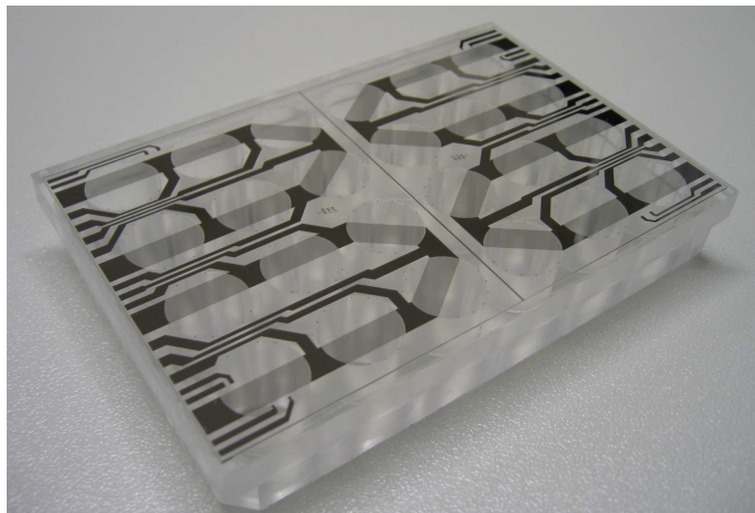
Abbildung 7.16: Zwei Exemplare der hergestellten Sensorplatten für Multiwellplatten-Systeme mit seriell geschalteten Impedanzsensoren die rückseitig auf eine 24-Well-Platte aufgeklebt sind
