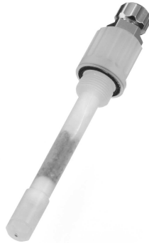
Abbildung 5.11: Verwendete Referenzelektrode der Firma Metrohm
