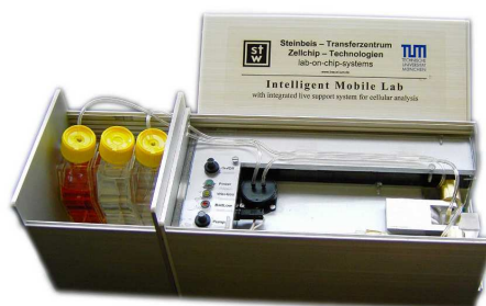
Abbildung 9.5: Mobiles Meßsystem zum Betrieb des multiparametrischen Sensorchips auf Keramik-substrat [250]
