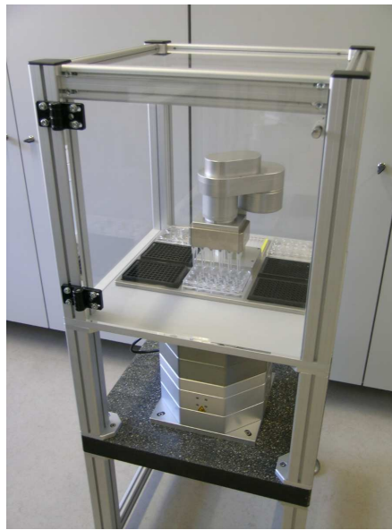
Abbildung 9.6: Meßsystem zum Betrieb von sensorgestützten Multiwellplatten mit Beprobungsroboter und Klimakammer [251]
