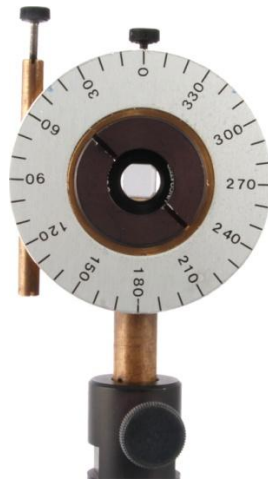
Abbildung 40: Drehfassung zur Montage der Verzögerungsplättchen.
