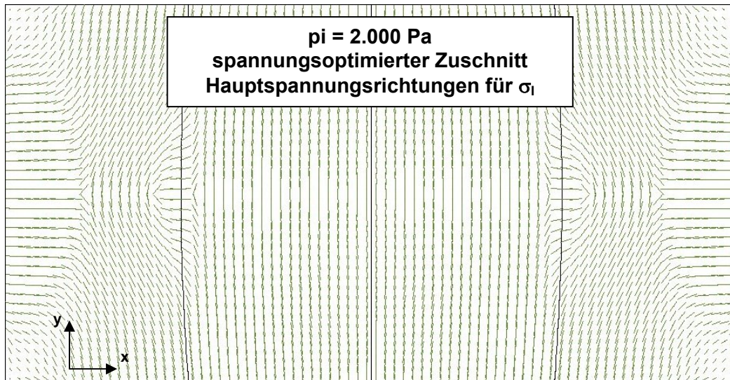
Abb. 4.100 a) Hauptspannung \sigma_I \text{ [N/mm}^2\text{]} ; b) zugeordnete Hauptspannungsrichtungen, Berstversuch 2003, spannungsoptimierter Zuschnitt (Vergleichsrechnung 2), p_i = 2.000 \text{ Pa}
