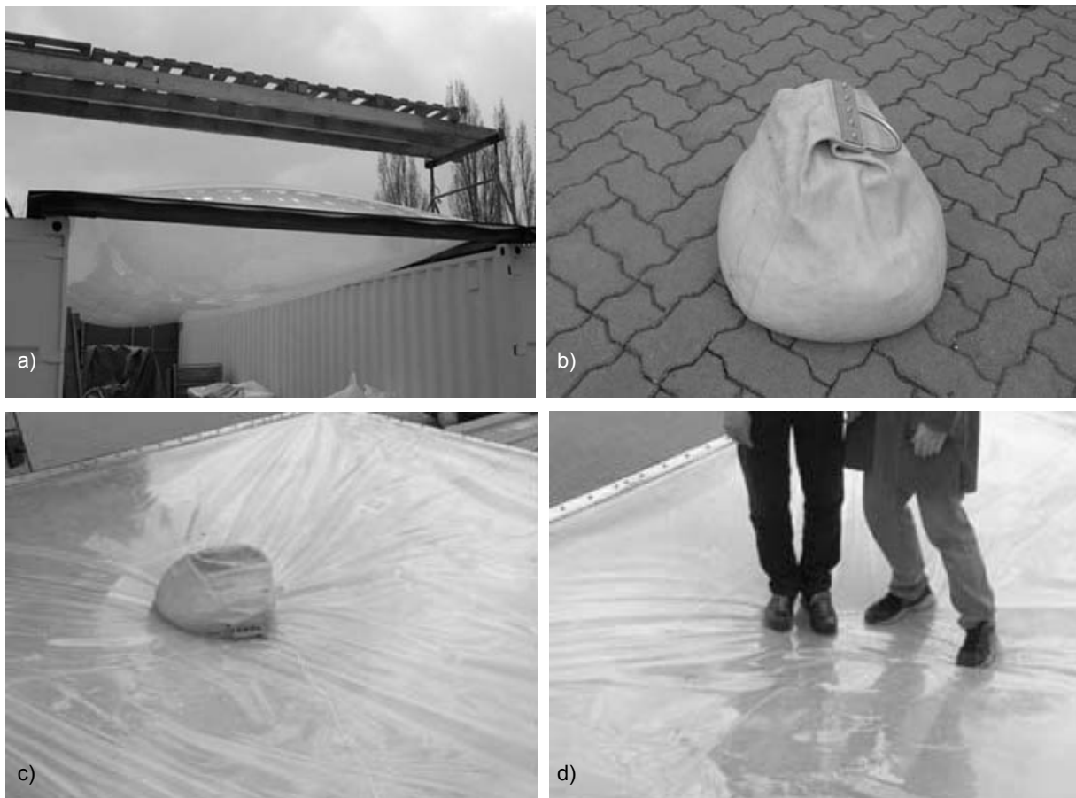
Abb. 4.129 Prüfung der Durchsturzsisicherheit in Anlehnung an Richtlinie GS Bau 18, 2003 [53]: a) ETFE-Folienpneu 4,0 x 8,0 m, dreilagig, d = 200 / 100 / 200 \mu\text{m} , ® NOWOFLON ET 6235 – transparent, Abwurfhöhe h_{ist} \cong 2 \text{ m} > h_{soll} = 0,6 \text{ m} b) mit Glaskugeln gefüllter 50 kg-Testsack (Fallgewicht) nach Richtlinie GS Bau 18 c) Auftreffstelle des zweiten Abwurfs (auf luftleeren Pneu), d) Anschließende Belastung der Auftreffstelle ( g_{ist} \cong 150 \text{ kg} > g_{soll} = 100 \text{ kg} )
