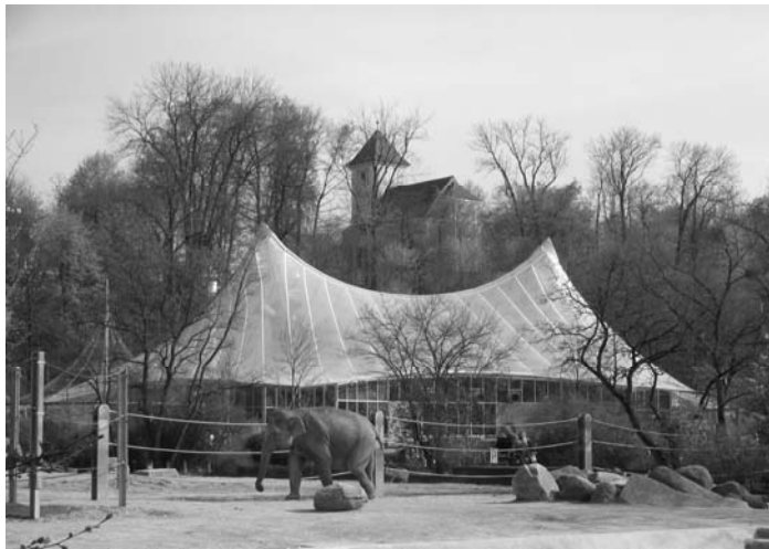
Abb. 1.19 Raubtierhaus im Tierpark Hellabrunn, ETFE-Pneus auf Seilnetz, München, 1994, Foto: K. MORITZ
