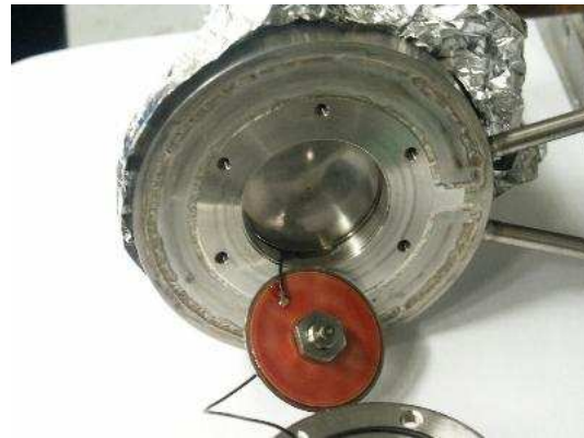
Abbildung 1.12: Vergrößerte Ansicht mit Blick auf die Frontplatte des Ventils und auf die Unterseite der Piezo-Scheibe.
