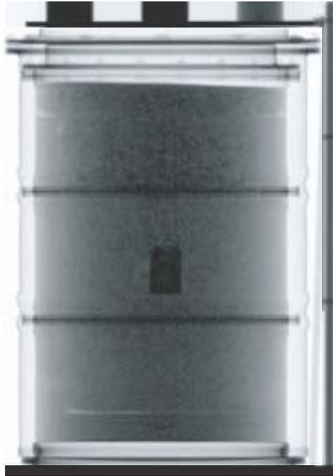
**Abbildung 6.5:** Schattenbild des Untersuchungsobjekts. Unterhalb des Gebindes ist ein Teil des Drehtellers zu erkennen. Zu Kalibrierzwecken werden vor einer DR-Messung am Untersuchungsobjekt jeweils verschiedene Körper mit bekannter Dichte angebracht. Im vorliegenden Schattenbild sind rechts am Gebinde die Kalibrierstäbe und auf dem Gebinde die Kalibrierzylinder aus Aluminium, Eisen und Blei (von rechts nach links) zu erkennen.
