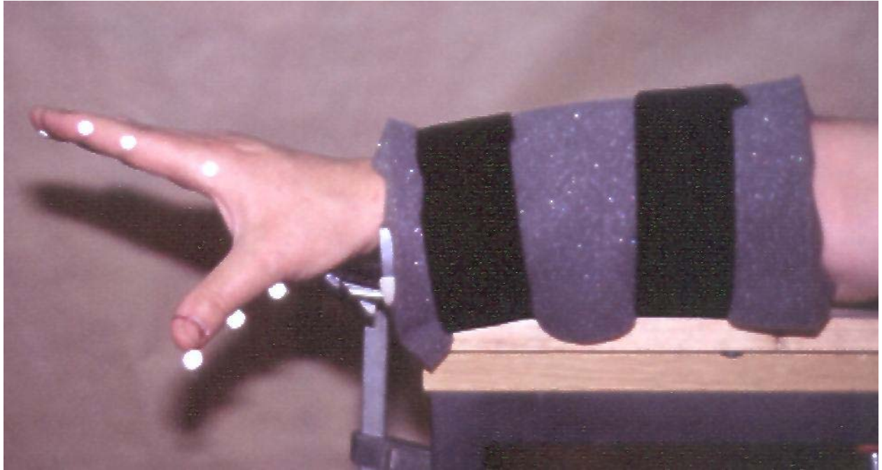
Abbildung 9: Markierung der Fingergelenke mit reflektierenden Marker für die Bewegungsanalyse
