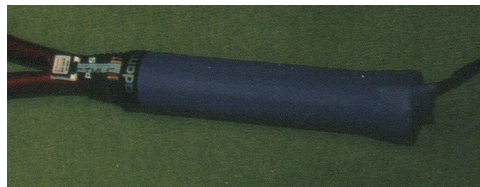
Abb. 6: Der Drucksensor wird durch einen Griffschlauch geschützt.
