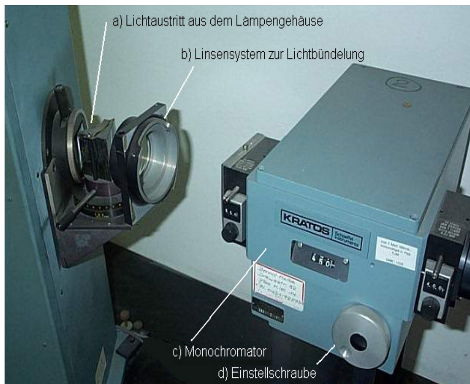
Abb. 2.2.5. Monochromator (Fa. Kratos) und Lampengehäuse mit Linsensystem (Eigenbau)
