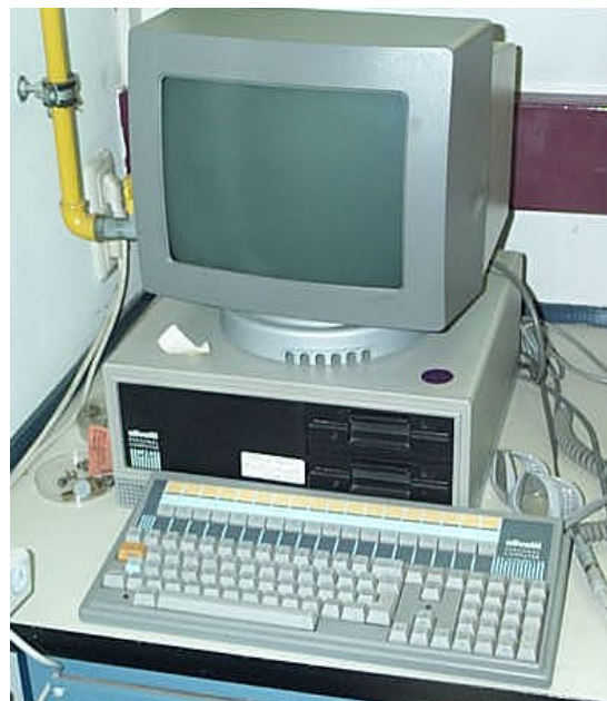
Abb. 2.2.6h. Computer Über den Computer Olivetti M24 wird das Beobachtungsmikroskop und die Videokamera gesteuert.
