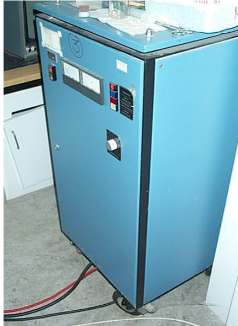
Abb. 2.2.4a. Spannungsgerät zur Versorgung der Xenonlampe Über eine 380 A Starkstromleitung wird das Spannungsgerät von extern versorgt.
