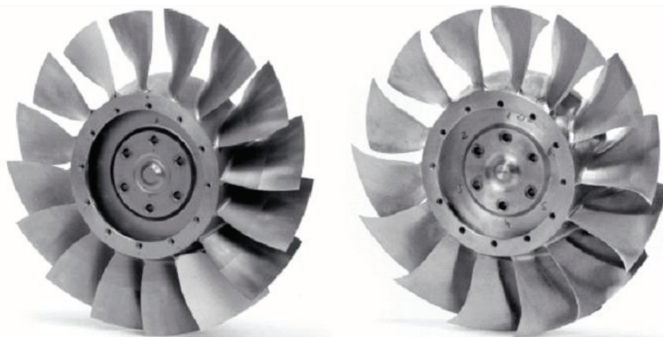
Abbildung 2-11: Experimentalverdichter an der TU Darmstadt in konventioneller Ausführung (links) und mit „Sweep“ im Blattspitzenbereich (rechts), aus [114]
