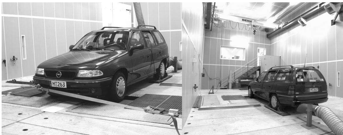
**Bild 4.3:** Das Versuchsfahrzeug auf dem Rollenprüfstand der TU München.
