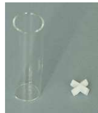
Abbildung 4.3 a) Aufbau des mL-Reaktorsystems auf dem Mehrfachrührplatz. b) Als mL-Reaktor verwendetes Glasgefäß mit Kreuzmagnetrührstäbchen.
