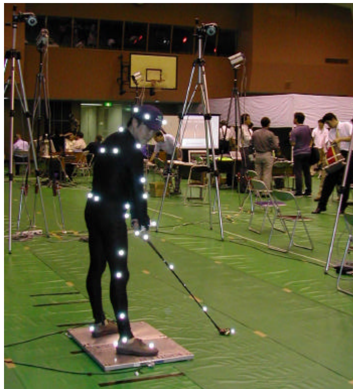
Abbildung 1.3: Klassische Methode zur Bewegungsmessung: Die Lage der Mar- ker, wird mit Hilfe von Bildverarbeitung dreidimensional ermittelt. Von der Raum- koordinate der Marker wird auf die Bewegung des Körpers geschlossen (Foto: Vicon).
